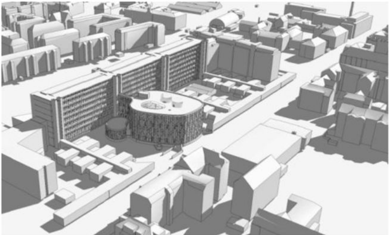
Eksempel på IFC-model placeret i bymodel, således at konkurrenceforslaget kan vurderes bygningsmæssigt i relation til sine omgivelser.
