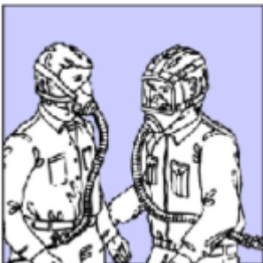
Fig. 1 - Luftforsyning åndedrætsværn - Kompressorforsyning hætte
