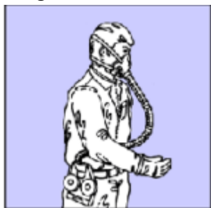
Fig. 4 - Filtrerende åndedrætsværn - Halvmaske med turboenhed (blæser) og filter i bæltet
