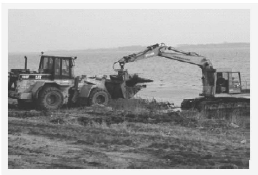
FIGUR 17: ENTREPRENØRMASKINER ANVENDES TIL AT SAMLE OLIE OP
