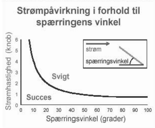
FIGUR 2: STRØMMENS PÅVIRKNING AF EN SPÆRRINGS EFFEKTIVITET
