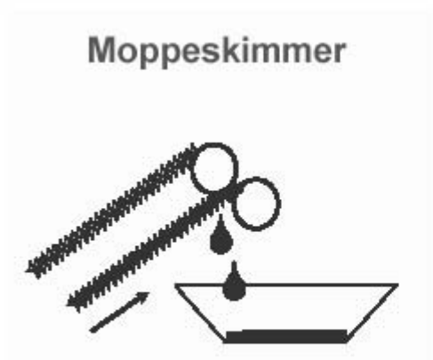
FIGUR 14: PRINCIPPET I EN MOPPESKIMMER. OLIE PRESSED FRA MOPPEN NED I ET OPSAMLING SICAR.
