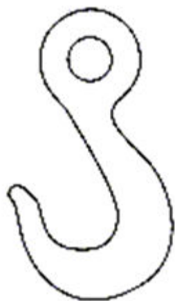
Fig. 1 Den på figur 2a viste krog har den ulempe, at det, der hænger i den, let kan hægtes af, fx hvis en byrde fisker under nedfiring.
