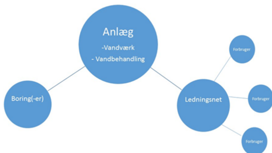
FIGUR 4.3 Principskitse for enkelt opbygget almen og ikke-almen vandforsyning.
