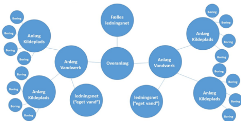
FIGUR 4.6 Principskitse for kompleks almen vandforsyning.
