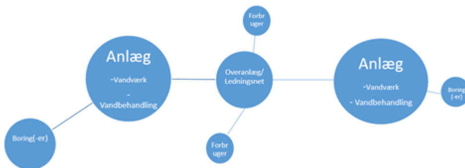
FIGUR 4.5 Principskitse for almen vandforsyning, flere anlæg - delt ledningsnet.
