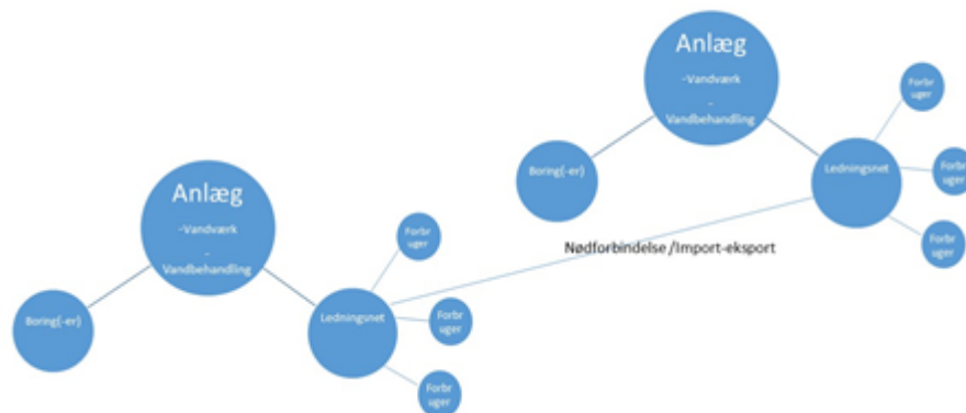
FIGUR 4.4 Principskitse for almen vandforsyning med import/eksport til anden vandforsyning.
