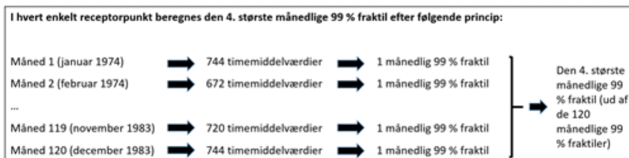
FIGUR 16. Princip for beregning af den 4. største månedlige 99 % fraktil i hvert enkelt receptorpunkt ved brug af 10 års meteorologi fra Aalborg (1974-83). Antallet af timemiddelværdier afhænger af antallet af dage i den enkelte måned.
