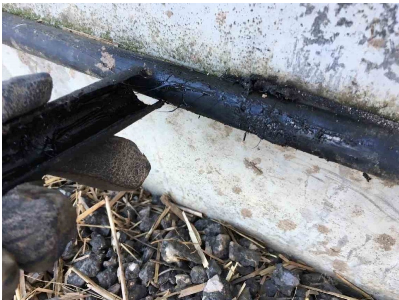
Foto 12. Samme reparation som på forrige foto. Der er smurt med et ukendt produkt mellem kabel og plastkappe, men plastkappen kan let tages af og reparationen er ikke vandtæt. Metoden vurderes ikke at have den fornødne ydeevne og holdbarhed.
