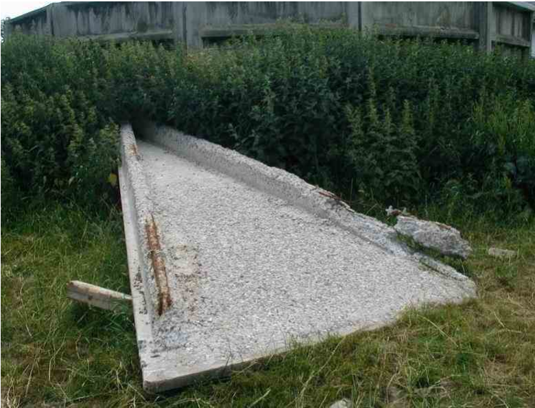
Foto 50: Beholderlåg (undersiden) fra gødningsbeholdere. Det er kraftigt eroderet som følge af manglende ventilation og en beholdervæske, der tilsættes industriaffald.
