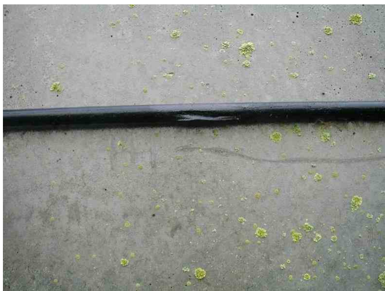
Foto 40: Kabler over terræn har ofte skader fra påkørsel eller andet.
